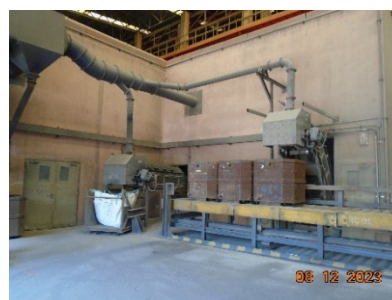
ภาพที่ 2-8 ห้องครอบเครื่องจักรพร้อมติดตั้งวัสดุดูดซับ
